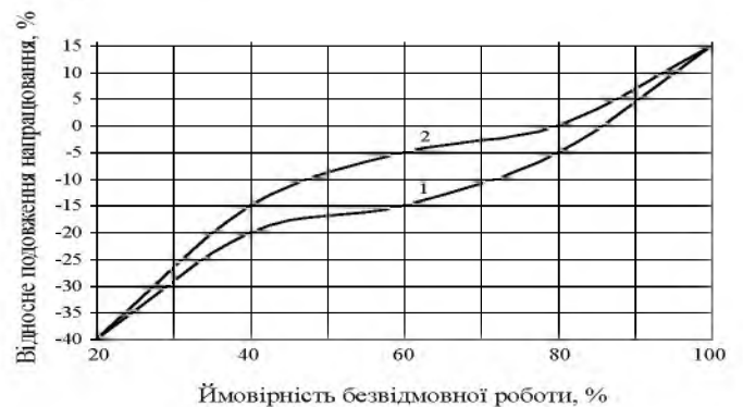
Рис. 11. Відносне подовження напрацювання (пробігу) вантажних вагонів при забезпеченні відповідного рівня їх ймовірності безвідмовної роботи під час експлуатації у випадку: 1 – миттєвої індикації відмов; 2 – відсутності самостійного прояву відмов
